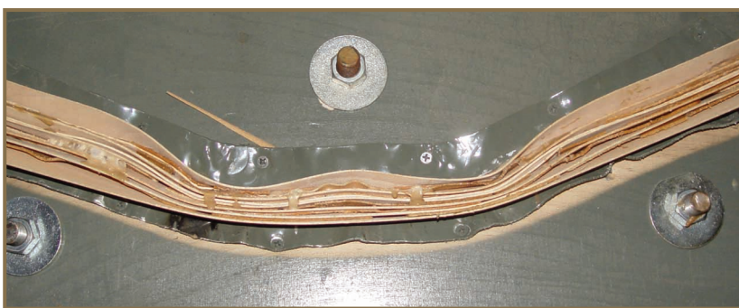
Fot. 5. Stosowanie form drewnianych obijanych blachą w procesie formowania przy użyciu generatora wysokiej częstotliwości obniża koszty oprzyrządowania kilkakrotnie oraz znacznie skraca czas produkcji (klejenia i formowania)
