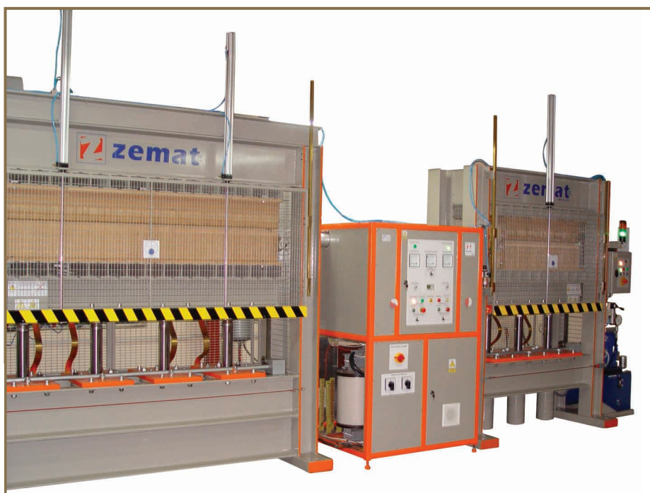
Fot. 2. Standardowy zestaw dwóch pras hydraulicznych i generatora wysokiej częstotliwości
