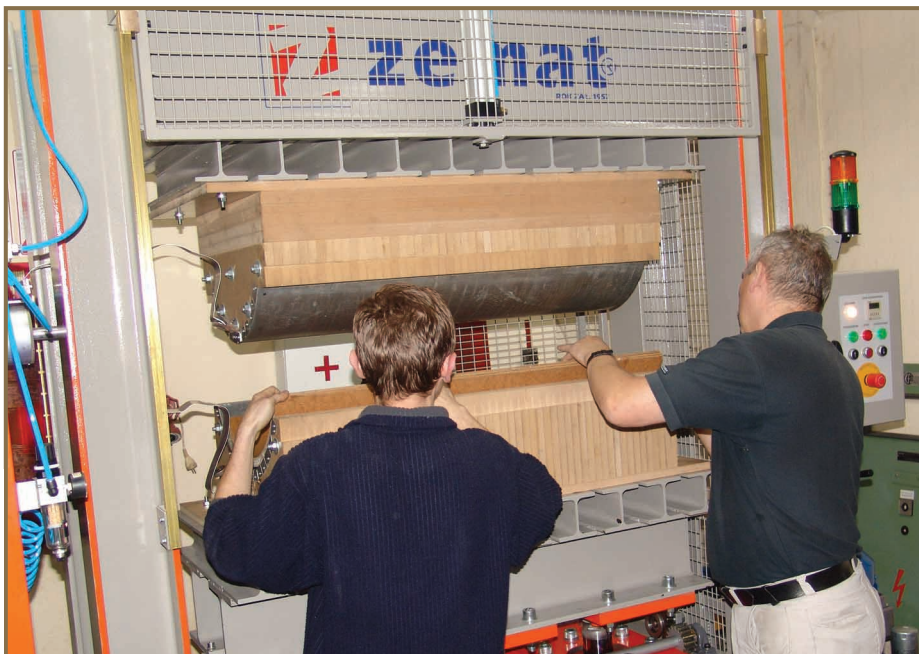
Fot. 7. Wyjmowanie uformowanej łuszczyki z prasy
