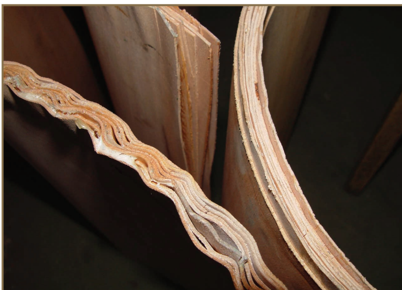
Fot. 4. Łuszcza po wstępnej obróbce (formowaniu) na prasie z generatorem wysokiej częstotliwości
